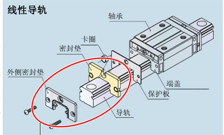
因线性导轨用密封垫的形状与导轨的沟槽形状完全吻合，导致涂在导轨上的润滑油无法进入轴承内。
